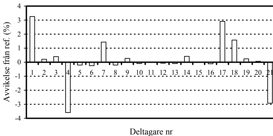
Figur 13. Provningsjämförelsen "Beräkning av rökgasflöden" år 2002. Avvikelse (i %) från "referensvärdet" för fall 3: Torrt rökgasflöde ( m^3(n\ tg)/h ).
